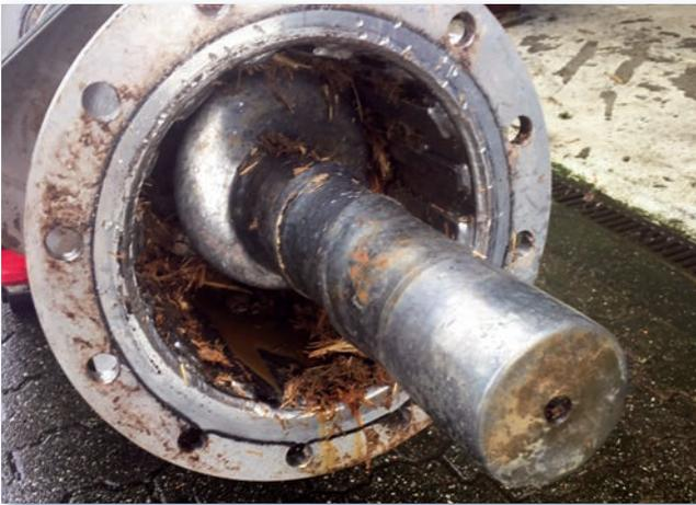
Auf dem **KLÄRWERK RATINGEN** bedurfte es der Erneuerung der Förderschnecke bei einer der beiden Rechengutwaschpressen, da die Wendel weitestgehend abgenutzt war.
